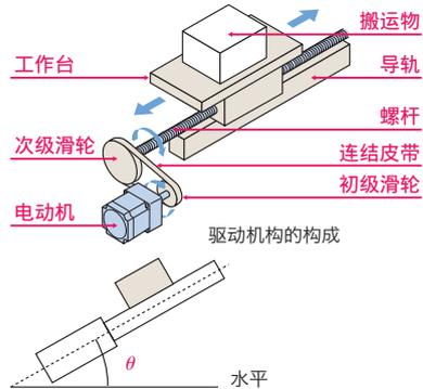
请在 使用 连结皮带轮或齿轮时填写。直接耦合连接则不需要。
