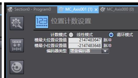
※ 本手册设定轴2使用带编码器电机，请按照实际使用情况进行设定
