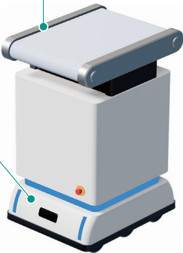
用途例：带传送带的自动搬运机器人
